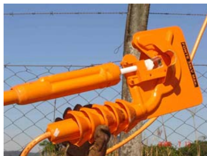
Figura 2 – Fixação da garra (sensor) no bastão de manobra.
